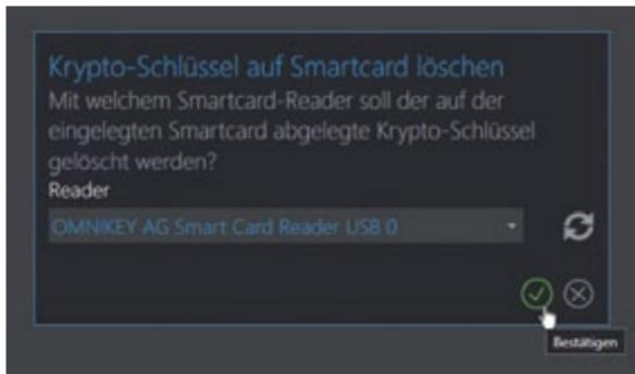
Geben Sie nun die PIN ein und bestätigen Sie abschließend mit . Der alte Krypto-Schlüssel wird nun durch die automatische Vergabe eines neuen Schlüssels gelöscht.
