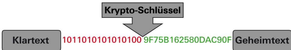
Die AES-Betriebsart Cypher Block Chaining (CBC) bezeichnet ein komplexes Verfahren, bei dem die einzelnen Klartextblöcke zunächst mit dem im letzten Schritt erzeugten Geheimtextblock verknüpft und erst anschließend mit dem AES-Schlüssel verschlüsselt werden. Auf diese Weise können keine Rückschlüsse auf die Klartexte gezogen werden, was eine extrem hohe Sicherheit garantiert.
