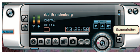
Bild 4: Bedienoberfläche „Modern Black Panel“, linke Skala Feldstärke, rechte vermutlich Bitfehlerrate (grün = optimal)
