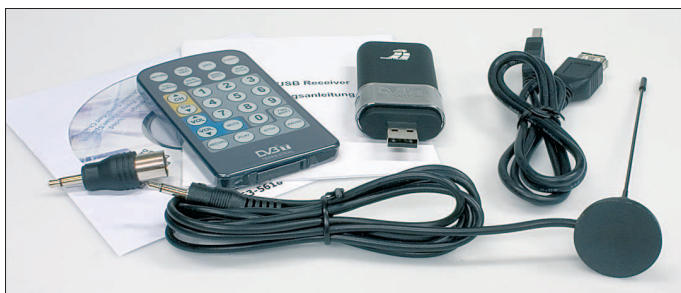
Bild 1: Lieferumfang des „DVB-T USB Stick“; letzterer ist in der Mitte zu erkennen. Besonders nützlich ist der Antennenadapter, links im Bild.
