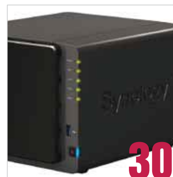
Der 4-Bay NAS-Server DiskStation DS416play hat einen 1,6 GHz Dual-Core-Prozessor
